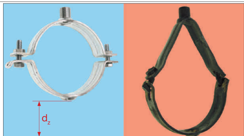
Rysunek 6.3: Obejma rurowa Stabil D-3G przed i po badaniu pożarowym / Sikla
